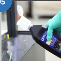
6% Peroxid-Lösung gemäß Dosierungstabelle ins Becken gießen (Schutzhandschuhe gemäß DIN EN 374 und Augenschutz gemäß DIN EN 166 tragen!) Hierbei ist die Menge für den Fall „Starke Verschmutzung“ anzuwenden.
