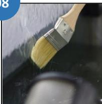
Parallel zum Spülvorgang müssen das komplette Becken, die Pumpe, die Schläuche und die Übergänge zur Seitenverblendung mit einem Pinsel (s. Servicekoffer) gereinigt werden.
