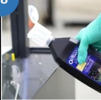
Geben Sie nun 6% Wasserstoffperoxidlösung gemäß Dosierungstabelle für „leichte Verschmutzung bzw. wöchentliches Nachfüllen“ hinzu (tragen Sie Schutzhandschuhe nach DIN EN 374 sowie einen Augenschutz gemäß DIN 166).
