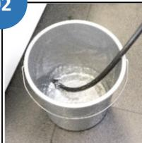
Tauchpumpe aus Servicekoffer aufrecht in das Becken tauchen, Schlauch in Kanister. Abfluss etc. hängen. Wasser vollständig abpumpen.
