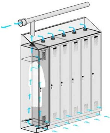
Unsere ZBL Technologie: hohe Luftwechselrate durch Anbindung an bauseitige Lüftungsanlagen.
