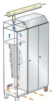
Notre technologie AF : taux de circulation de l'air élevée par raccordement au système d'aération chez le client.
